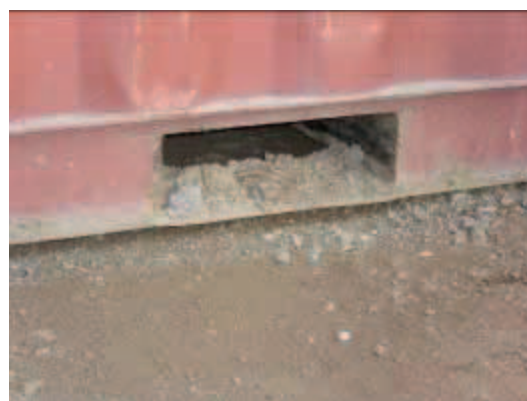
Figure 6.3 – Boue dans un passage de fourches
