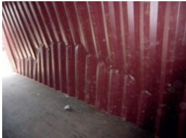
Figure 7.50 – Paroi latérale endommagée d'un engin de transport
