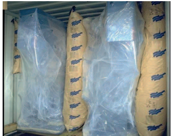
Figure 7.10 – Colis de forme irrégulière immobilisés à l'aide de sacs d'arrimage
