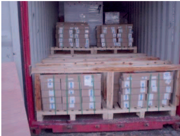
Figure 7.2 – Plancher temporaire en bois
