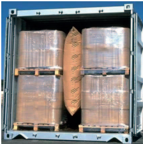
Figure 7.9 – Espace rempli par un sac d'arrimage central
