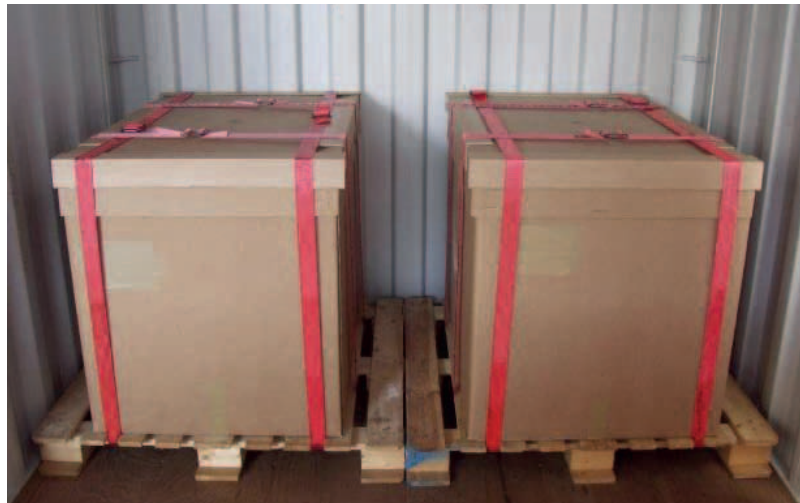
Figure 7.8 – Cargaison solidement assujettie à des palettes au moyen de saisines en textile
