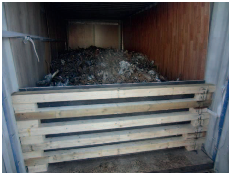
Figure 7.55 – Engin de transport chargé de ferraille doté d'un revêtement au niveau des parois et d'une barrière de porte
