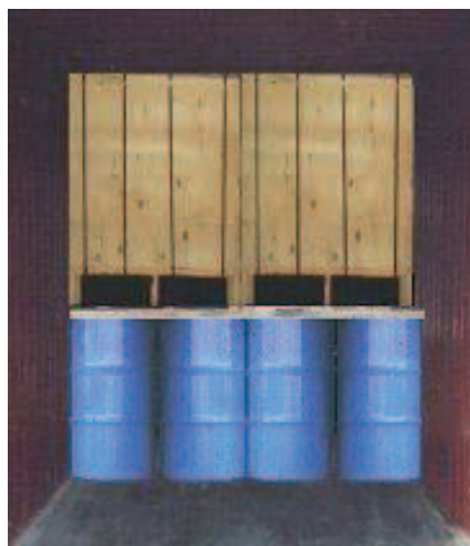
Figure 7.27 – Arrimage mixte avec des marchandises sèches au-dessus de marchandises humides
