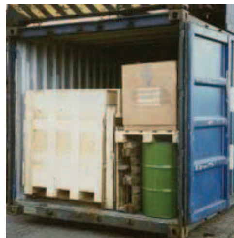
Figure 7.28 – Arrimage mixte avec utilisation de palettes
