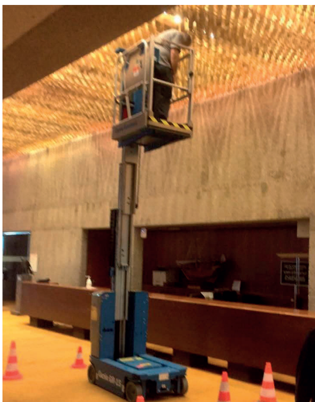
Slika 18. Pokretna podizna radna platforma koja se koristi u kancelariji za promenu sijalica.
