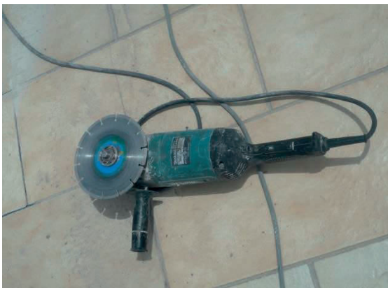
Slika 48. Neobezbeđeni ručni rezač/brusilica
