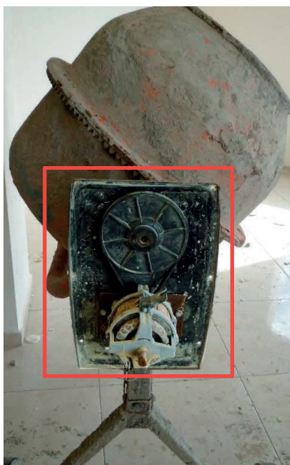
Slika 45. Nebezbeđeni pogonski mehanizam na mešalici za beton
