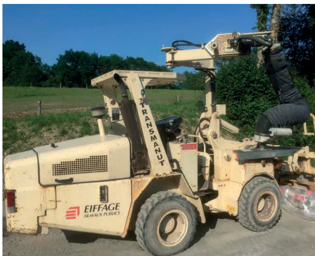
Slike 37 i 38. Vakuumska dizalica za prenošenje kamenih blokova.
