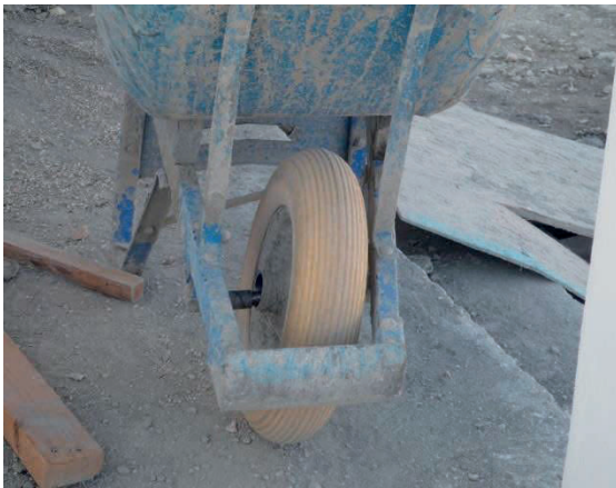
Slika 50. Kolica sa loše održanim ležajem točka.
