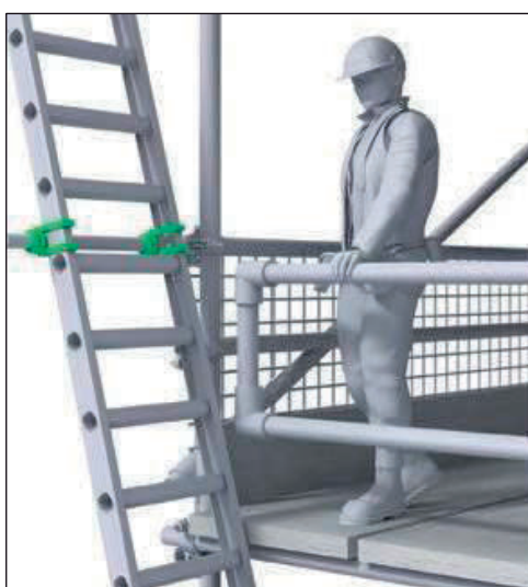
Slika 12. Pravilno postavljene i obezbeđene merdevine pored platforme za pristup.
