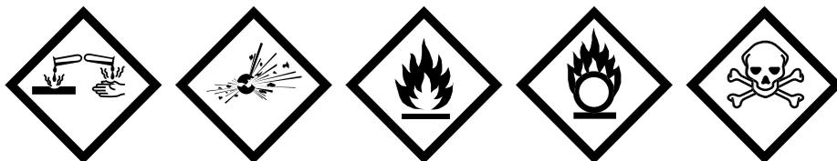
De gauche à droite, ils représentent les dangers de corrosion, d'explosion, d'incendie, d'agents oxydants et d'empoisonnement.
