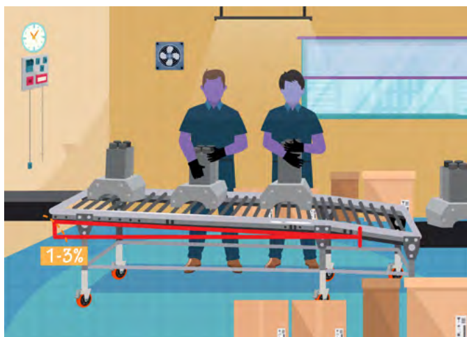
► Figura 5d. Transportador de rodillos inclinado para mover productos pesados.
