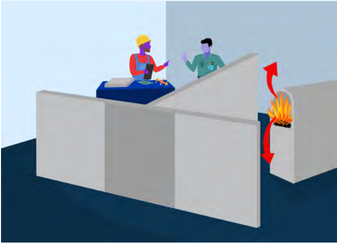
► Figura 21a. Utilice mamparas para separar las fuentes de calor.
